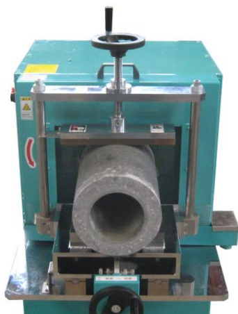
パイル供試体セット状況
