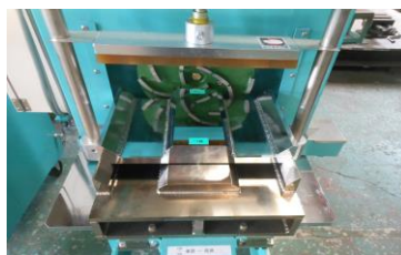
押し抜き型枠用 (テーパ) \phi 125 \times 250\text{mm}
